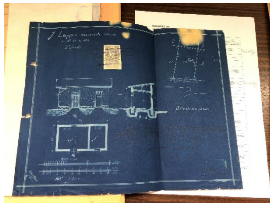
93. Diasotüüpidega vahetus kontaktis olnud tsüanotüüp. Kujutise kahjustused on tekkinud arhiivinumbri kleepimiseks kasutatud liimist (VM 9554:33/11 Ar).
