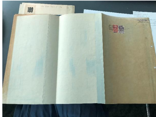
91. Kokkuvolditud tsüanotüübi välimine osa on tugevalt koltunud, mille põhjuseks on tõenäoliselt pikaaegne kontakt happelise kiirkõitja kaanega (VM 9554:50/6 Ar).
