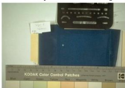
16. Tsüanotüübi näidis pärast umbes nädalapikkuse näituse 50 lux valgustugevuses eksponeerimist.
