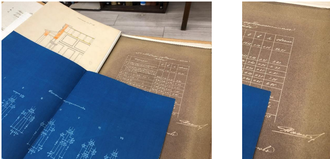
113., 114. Tsüanotüüp (TLA.149.6.124/3) ja vandyke'i – koopia (TLA.149.6.124/4) on olnud vahetus kontaktis. Vandyke'i kujutis on servades muutunud heledamaks.
