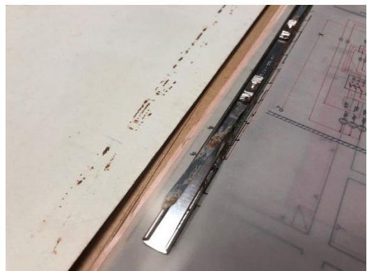
121. Roostes klambrid on tekitanud joonistele plekke.
