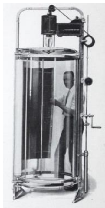
6. Originaaljoonis koos kopeerimispaperiga kinnitati silindrile spetsiaalse peale rullitava kattega (The C. F. Pease Company, 1928).
