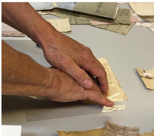
37. Dest. veega niisutatud indikaatorpaber surutakse raud (II) ioonide testimisel lühikeseks ajaks vastu joonist.
