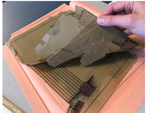
80. Räbaldunud paberkalka lahtivoltimisel tekivad kergesti uued rebendid.
