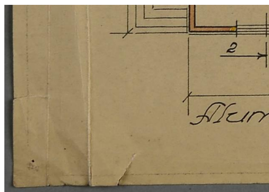
58. Originaaljoonise varju kujutis lehe servades näitab, et tegemist on koopiaga, mitte tušijoonisega (HMK 9118 Ar 5498).
