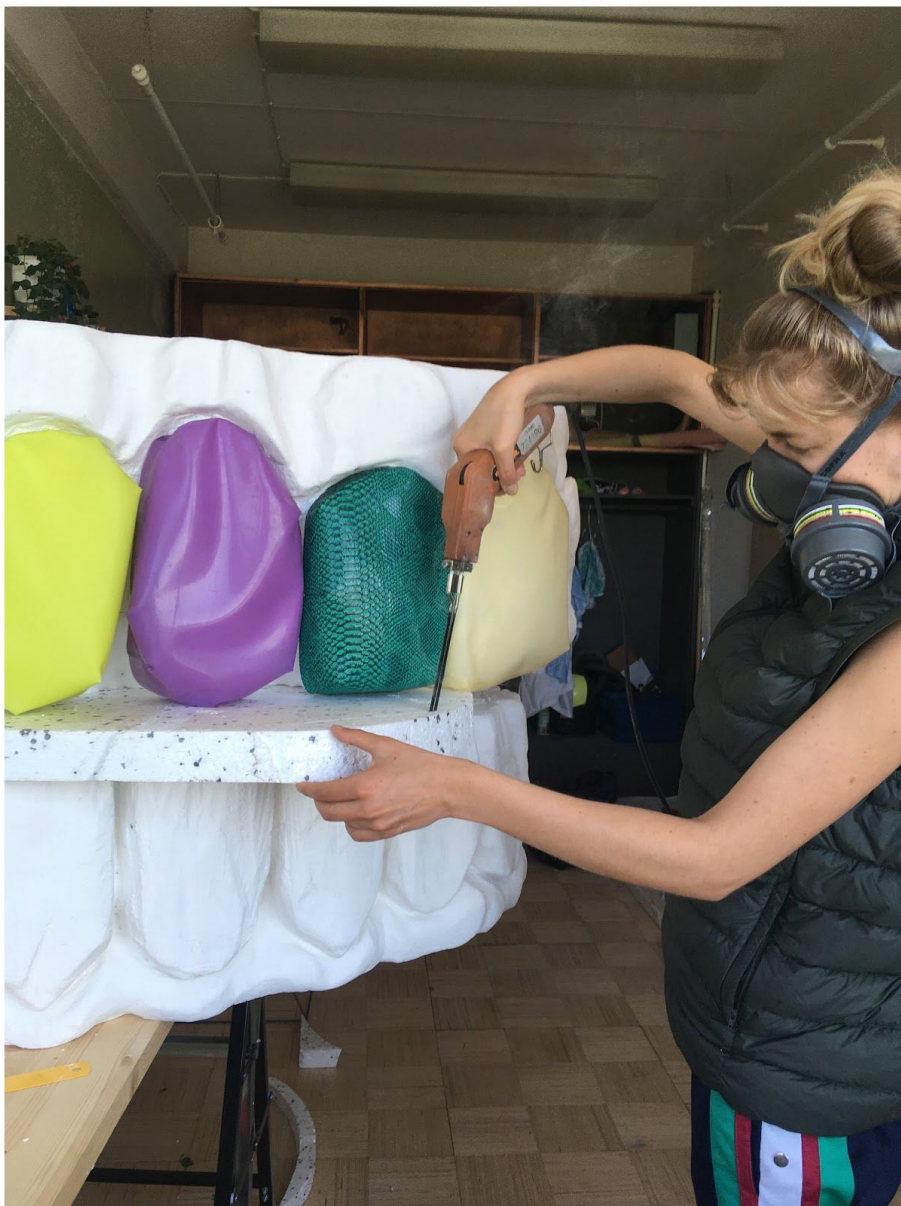
Stürovahu lõikamine kuuma noaga Põhjala stuudio, 2020 Pilt: Iaroslav Iakubivskiy
