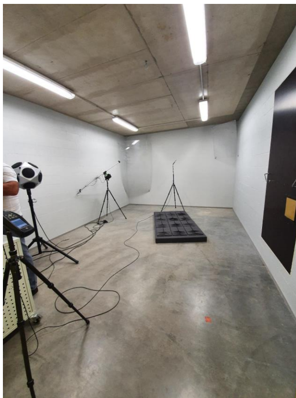
Joonis 3-17 Mõõtmise akustikalaboris suletud moodulitega Allikas: Kibbermann 2020
