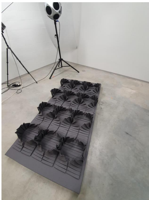
Joonis 3-18 Mõõtmise akustikalaboris avatud moodulitega Allikas: Kibbermann 2020
