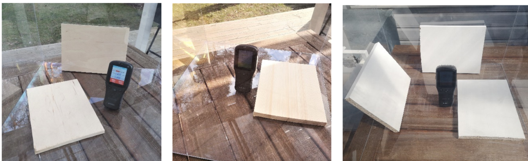
Illustratsioon 9. Mõõdetud puitmaterjal. Vasakult: vineer 12 mm, liimpuit, melamineeritud puitlaastplaat
