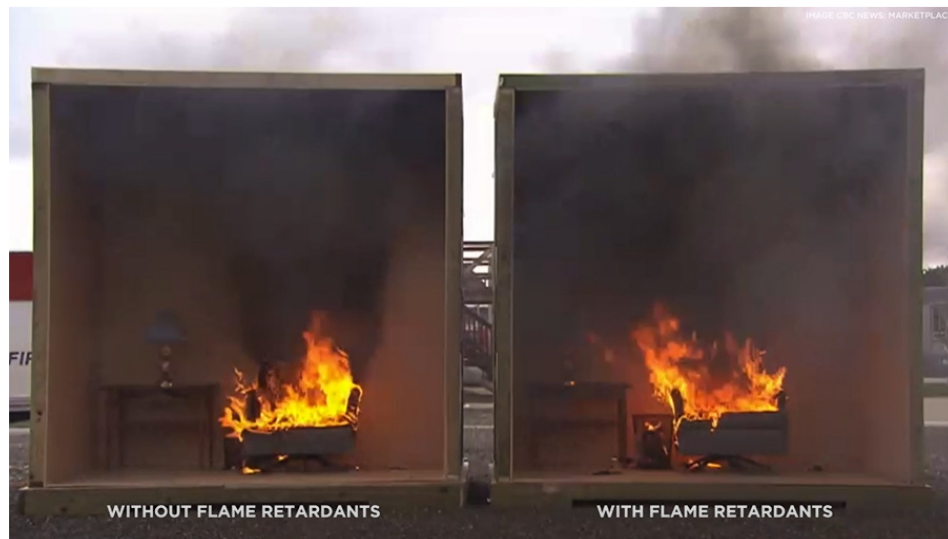
Illustratsioon 6. Leegiaeglusti hoiab tulekahju eemal vaid mõned sekundid 26
