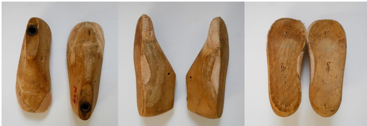
Joonis 14 Jala mõõtude ja kuju järgi kohandatud liistu vaated. Fotod: Maarja Linsi
