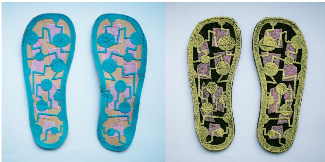
Joonis 20 Siidiraamiga trükitud nädistallad taimparknahale (vasakul) ja lambavillast vildile (paremal). Mõlema katsetuse puhul toimis mahuline värv hästi. Materjalide pinnastruktuuri erinevuste tõttu on nahktalla trükipind siledam ning villtalla pind krobelisem. Fotod: Maarja Linsi
